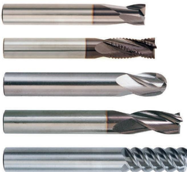
Fresas de topo de ampla aplicação e alto rendimento para operações de desbaste e acabamento, inclusive em high speed machining, com geometrias adequadas à usinagem de materiais endurecidos para correção das deformações de tratamento térmico e sem necessidade de refrigeração, para preservação do meio ambiente e redução de custo.
